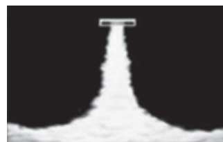
Работа вихревого диффузора в режиме нагрева
